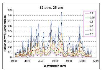
FIGURE 4. SIMULATED COMBUSTOR EXIT SPECTRA AS A FUNCTION OF EQUIVALENCE RATIO.
